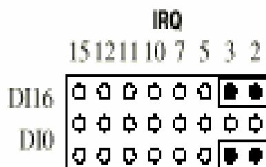
Рис. 8.5.4. Джамперы вектора прерываний для запрета прерываний .
